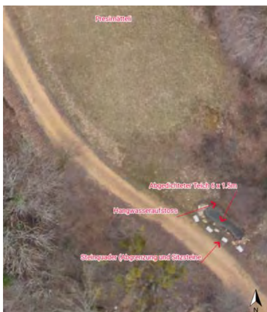
Objekt Nr. 3 ist ein ca. 8 m 2 grosser und 40cm tiefer Teich.
